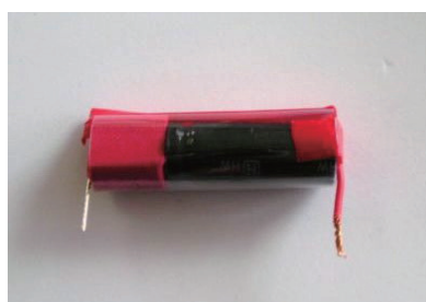
図18 加工後のコンデンサ 足が折れるのを防ぎ、かつ極性が分かるように加工。
