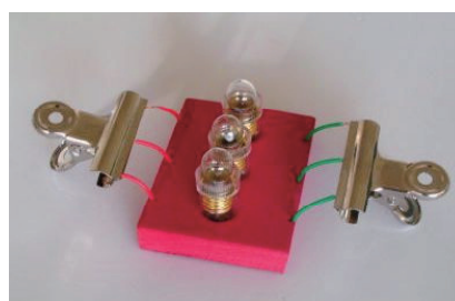
図16 並列に接続 目玉クリップをつなげば並列に、外して1つずつ接続も可。
